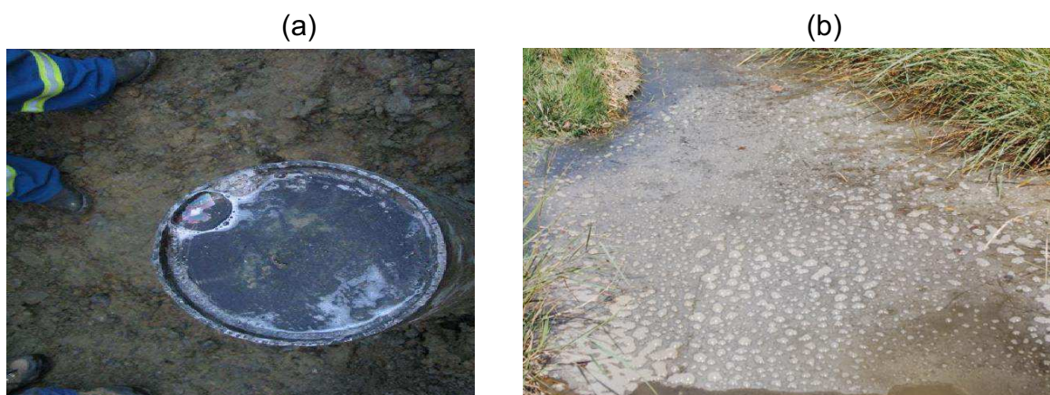
Figure 23 : Exemples de fuites diffuses de CO 2 : (a) formation de bulle en tête d'un puits (Bachu, 2007) ; (b) apparition de bulles à la surface d'une mare au voisinage de la source thermique de Sainte Marguerite (63)
